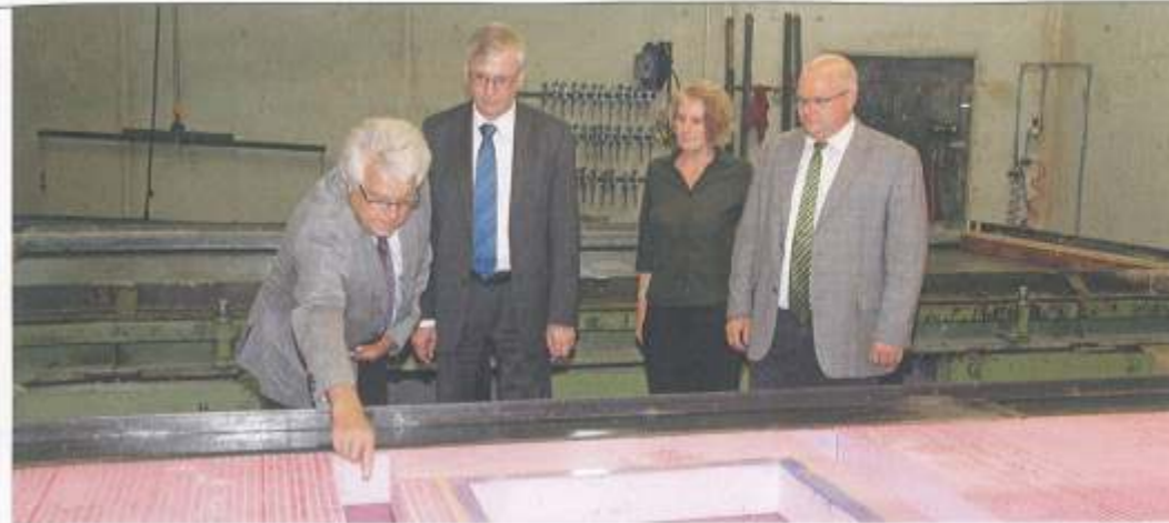
Rainer Knecht (links), seine Tochter Sandra Knecht und Bernd Hetzer (rechts) erklären die Produktion. Die Dämmung wird in eine Palette eingelegt. Danach betoniert man darauf und durch die Rillen im Dämmmaterial „verzahnt“ sich der Beton mit der Dämmung.
