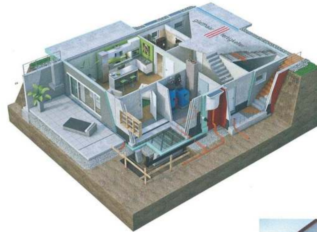
Ein auch unterhalb der Fundamentplatte gedämmter Wohnkeller: Den Kosten eines Kellers steht der höhere Wiederverkaufswert des Hauses gegenüber. Glatthaar
